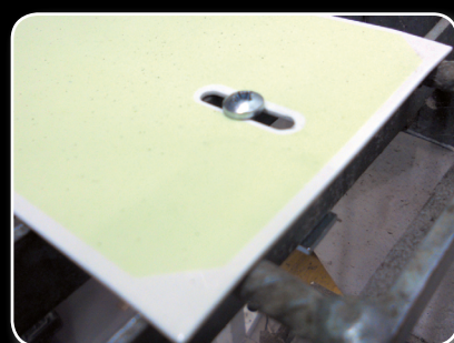
3. Skruene festes gjennom ledestripens hull ned i brikken. Skru hardt til slik at det sitter godt.
